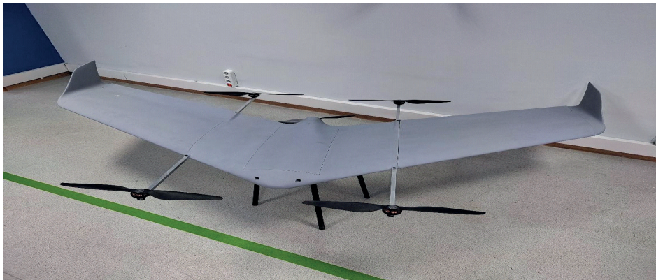
Рис. 3 – Универсальный дрон для мониторинга на основе конвертоплана
