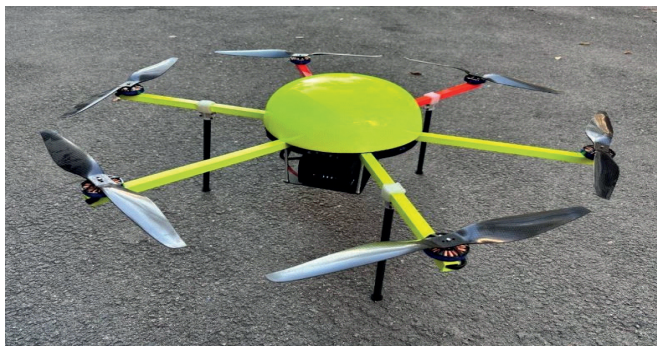
Рис. 2 – Универсальный дрон для мониторинга на основе гексакоптера
