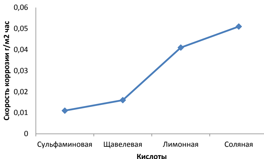
Рисунок 2 - Зависимость скорости коррозии на образцах, активированных различными растворами кислот и обработанных ингибитором
