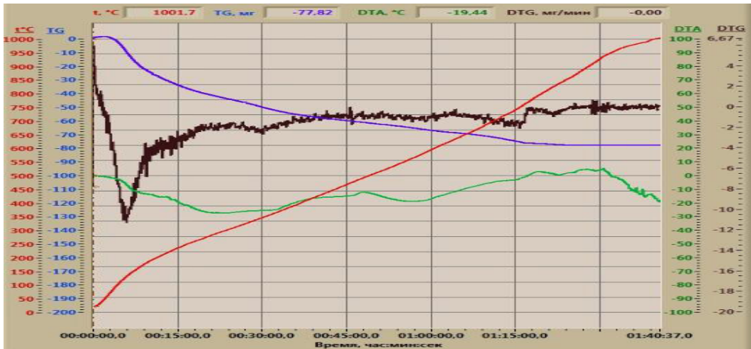
Сурет 6. ДТА/ТГ зерттелетін цеолит үлгісін талдау
