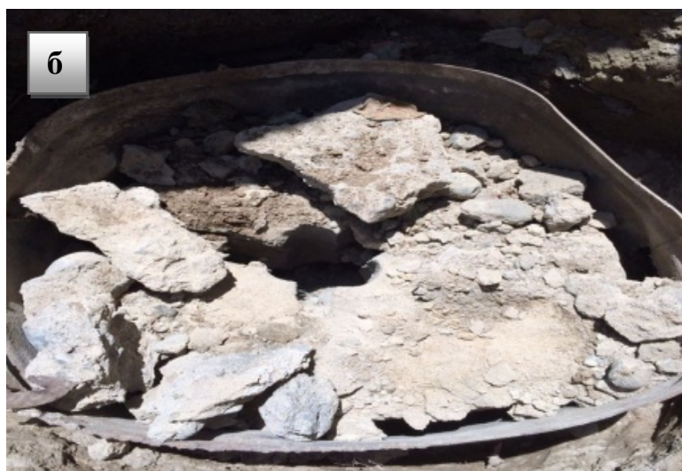
Рисунок 1 – Разрушения бетонных блоков закрытыми броневой оболочкой: а – монолитный бетонный блок; б – монолитный бетонный блок разрушенный ГХП
