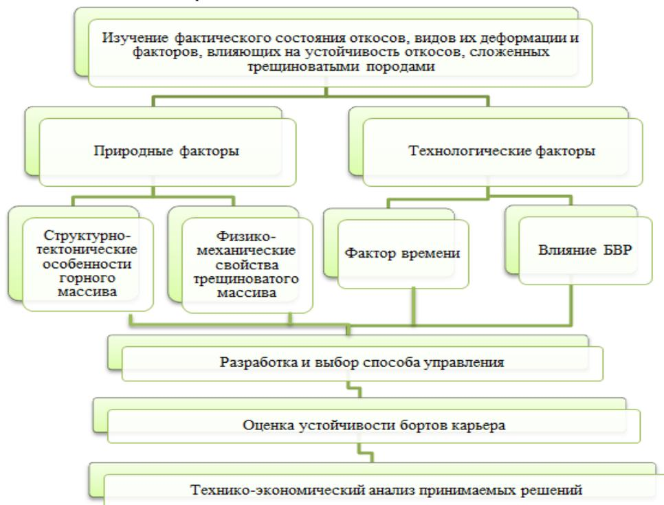
Рисунок 1 - Систематизация по управлению устойчивостью бортов карьеров
